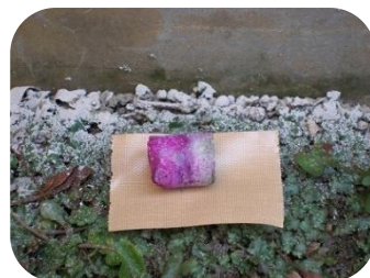
コンクリート中性化測定
